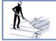
Utilice concreto de  $f_c=200 \text{ kg/cm}^2$  formando una capa de compresión de 3 a 5 cm según lo establecido en el diseño de la losa. No forme grandes montones de concreto, Asegurese que la malla quede colocada dentro de la capa de compresión. Extreme precauciones cuando utilice bovedillas de poliestireno y concreto bombeado, no dejando caer el concreto directamente sobre la bovedilla. Coloque tablines para caminar sobre la losa.
