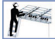
Cuando existan huecos tápelos con bolsas de cemento así evitara consumo innecesario de concreto a la hora del colado.
